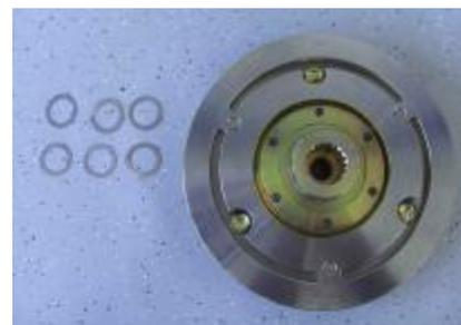
Paßscheiben auf die richtige Anzahl reduzieren und Ankerscheibenbaugruppe wie oben beschrieben Luftspalt nochmals messen und Spannschraube DIN933 M10x30-10.9 mit einem Drehmomentschlüssel mit 70Nm anziehen. Dabei mit Gabelschlüssel Größe 41 an der Schlüsselfläche der Ankerscheibenbaugruppe gegenhalten.
