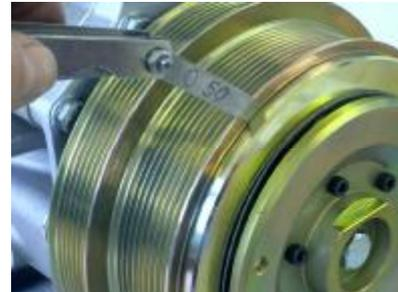
Wenn der Arbeitsspalt zu groß ist, Ankerscheibenbaugruppe demontieren. Dazu Spannschraube M10 öffnen und herausnehmen. M16 Schraube als Abdrückschraube benutzen und in die Ankerscheibenbaugruppe einschrauben wie im Bild unten dargestellt. Dabei an der Ankerscheibenbaugruppe mit einem Gabelschlüssel Größe 41 gegenhalten.
