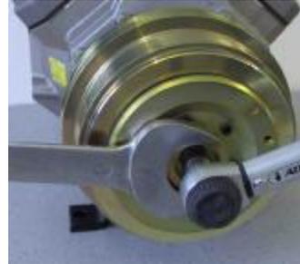
**Achtung:** Nach Beendigung der Montage der Kupplung den Rotor von Hand drehen und auf den Freilauf des Rotors und Geräuschbildung achten. Im Falle von Schleifgeräuschen oder schwergängigem Lauf des Rotors die Kupplung demontieren und prüfen.
